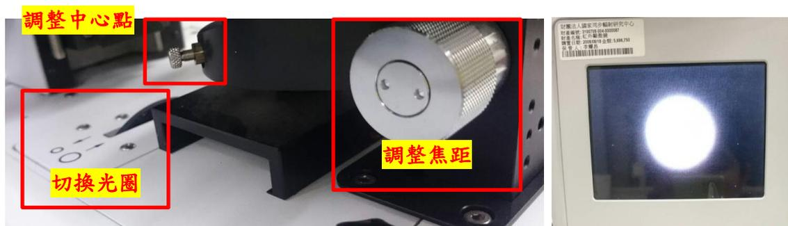
→ 完成後切換成大光圈 → 切換成 MIR 光源
